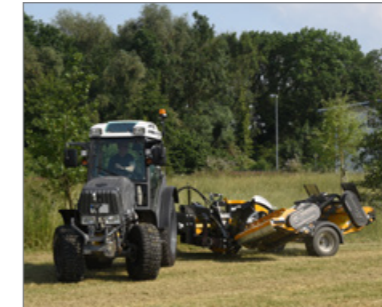
Für eine einfache Bedienung sind Klapp- und Vorgewendezylinder getrennt ausgeführt.
