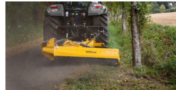
Ein großzügiger Verschiebbereich ermöglicht das Arbeiten sowohl hinter als auch neben dem Traktor. Enge Zufahrten und Seitenstreifen können gleichermaßen gemulcht werden.
