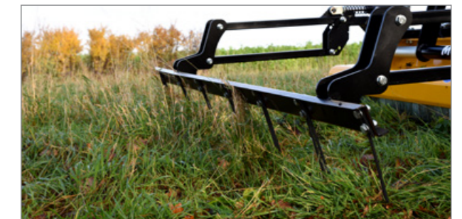
Insektenretter: durch einen speziell konzipierten, hydraulisch klappbaren Bügel mit integrierten abgewinkelten Zinken werden Insekten und Kleinstlebewesen vor dem Mulchgerät aufgeschreckt und zur Flucht bewegt. (optional für Arbeitsbreiten von 1,60 m und 2,20 m)
