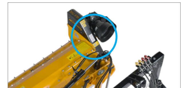
Keilriemenspannung immer im Blick: Keilriemenschutz mit Kontrollöffnung.
