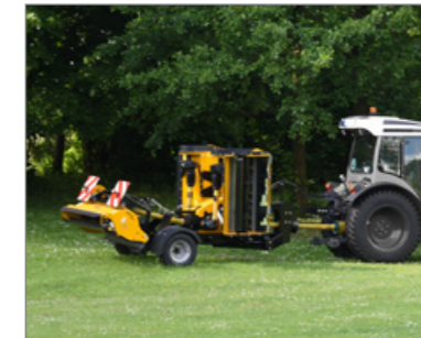
Geringe Transportmaße und eine Fahrwerkskonstruktion mit breiter Bereifung sorgen für eine ruhige und bodenschonende Fahrt.
