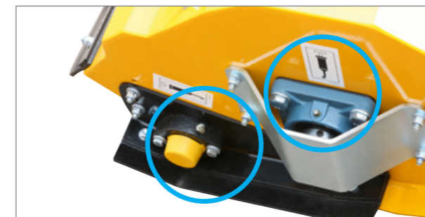
Gut zugängliche Lagerstellen für eine schnelle Wartung.
