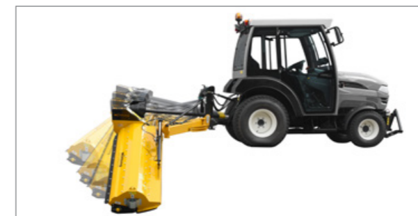
Mechanische, patentierte Anfahrtsicherung löst zuverlässig aus und kehrt selbständig in Arbeitsposition zurück.
