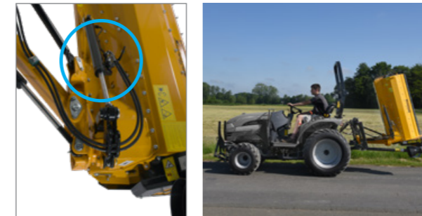
Sichere Transportverriegelung bei Straßenfahrt oder beim Transport des Gespanns mit dem PKW-Anhänger.
