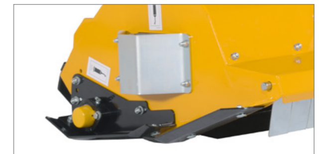
Hardox™-Verschleißkufen für hohe Standzeiten serienmäßig.
