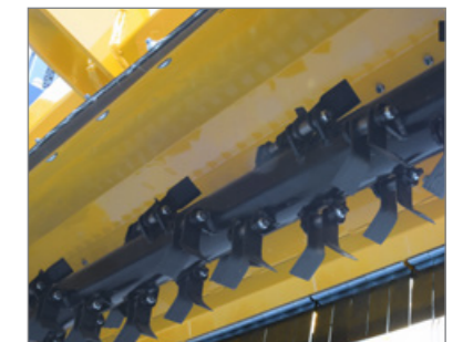
Durch die am Rotor montierten speziellen Y-Messer bei einer variabel verstellbaren Arbeitshöhe bis ca. 11 cm entsteht eine geringere Sogwirkung, wodurch Reptilien und Kleinlebewesen am Boden verbleiben und nicht mit den Y-Messern in Kontakt kommen.
