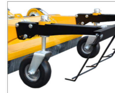
Höhenverstellbare Stützräder 360 Grad schwenkbar
