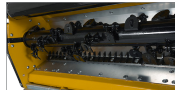
Verschleißeinlage für den rauen Alltag bei Dienstleister und Kommune (optional).
