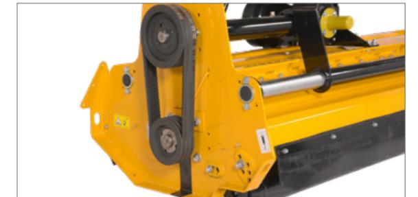
Zapfwelldrehrzahlen von 540 oder 1.000 U/min sind möglich.
