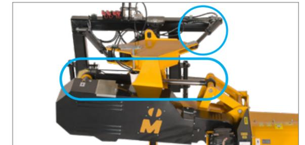
Die hydraulische Non-Stop Anfahr-sicherung schwenkt das Mulchgerät im Ernstfall effektiv aus dem Kollisionsbereich.
