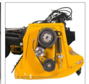
Störungsfreies und wartungsarmes Arbeiten durch die effektiv ausgeführte automatische Riemenspannung.
