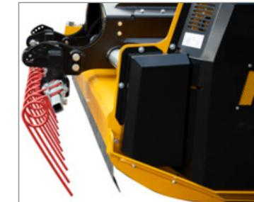
Die integrierten Striegel mit 16 Non-Stop Zinken dienen der Aufrichtung von angelegten Stoppeln vor dem Mulchgang und Erzeugung von Feinerde.
