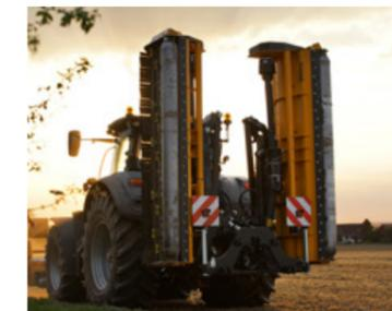
Clever geklappt: Minimale Gerätehöhe durch Parallelogrammaufhängung der beiden Mulchgehäuse.
