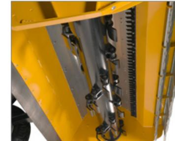
Leistungsreserve: Der massiv und groß dimensionierte Rotor.
