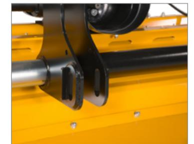
Langlöcher in Kat. 2 an den Ober- und Unterenkerbaupunkten ermöglichen zusammen mit der Schwenk-Stützwalze eine sehr gute Boden Anpassung.
