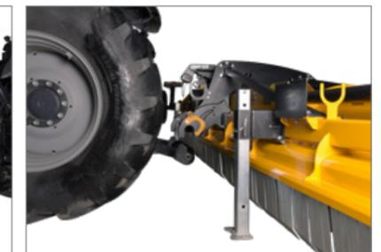
Schnell einsatzbereit: Maschine abhängen und Langfahrereinrichtung in Arbeitsposition bringen / MU-Farmer® 670 mit der Schnellkuppelstange am Traktor einhängen und Gelenkwelle anschließen.
