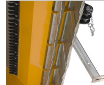
Zweifache Sicherheit mit doppeltem Pendelklappenvorhang aus Federstahl.
