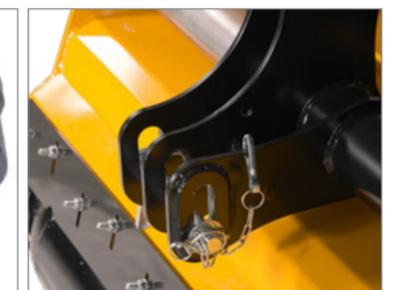
Langlöcher an den Ober- und Unterlenkeranbaupunkten ermöglichen zusammen mit der Schwenk-Stützwalze eine sehr gute Boden Anpassung.
