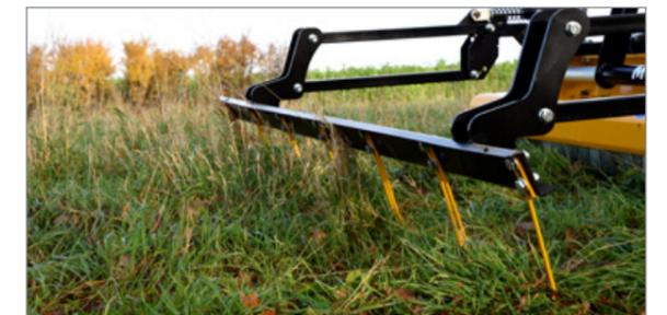
Insektenretter: durch einen speziell konzipierten, hydraulisch klappbaren Bügel mit integrierten abgewinkelten Zinken werden Insekten und Kleinstlebewesen vor dem Mulchgerät aufgeschucht und zur Flucht bewegt. (optional für Arbeitsbreiten von 1,60 m und 2,20 m)
