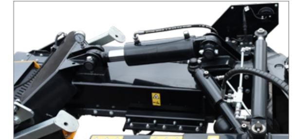
Hydropneumatische Auflagedruckentlastung für optimale Bodenanpassung.
