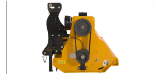
Direkte Kraftübertragung durch vorgespannte Riemen erstklassiger Qualität.
