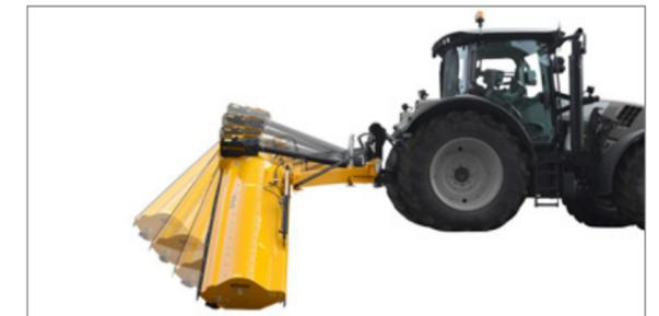
Mechanische, patentierte Anfahrtsicherung löst zuverlässig aus und kehrt selbständig in die Arbeitsposition zurück.
