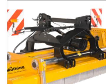
Robuster Front- Heckanbaubock mit hydraulischer Seitenverschiebung (56 cm Verschiebeweg) und Kat. 2+3 Anbaupunkten.
