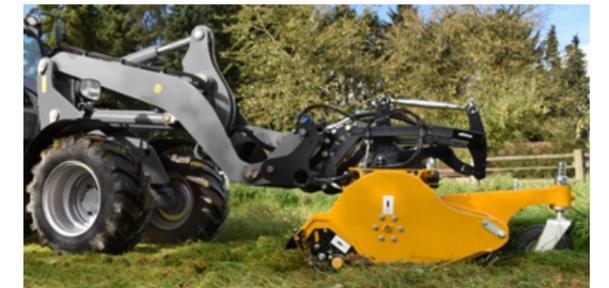
Virtueller Zugpunkt- Ein Müthing Patent: Das Mulchgerät wird mit geringem Rollwiderstand gezogen anstatt geschoben und folgt so jeder Bodenkontur perfekt.
