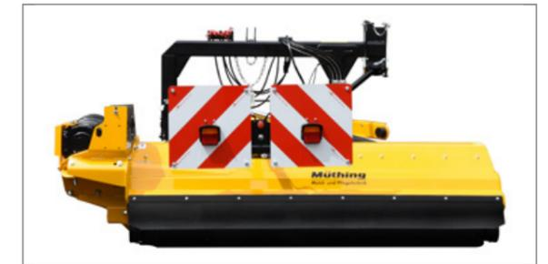
Drehbare Warntafeln mit LED-Beleuchtungseinrichtung und Beleuchtungsträger robust befestigt ohne bewegliche Bauteile(optional).
