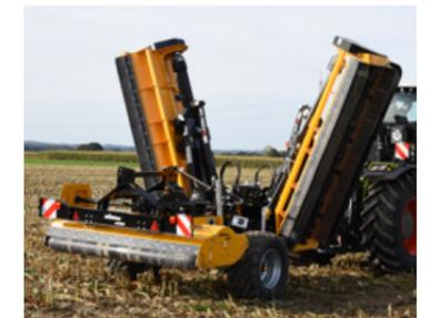
Schnelles Ein- und Ausklappen bei einer Transportbreite unter 3 m.
