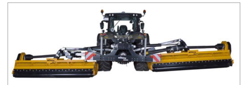
Die Mulchgehäuse lassen sich auch einzeln ausheben.
